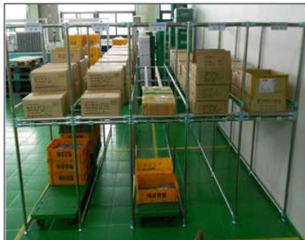
* 조립실 선입선출 랙(좌)과 Q Chart 및 신속대응 추적 PANEL을 통한 유효성 검증 모습(우)
